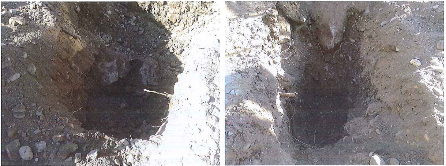
Fig. 1 e 2 – Saggi con escavatore eseguiti in data 29/01/2016 per l'accertamento di eventuale terreno inquinato
